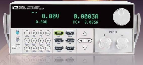
IT8912E为LED测试专用电子负载,应用于仿真不同特性的LED灯,采用硬件电路实现CR-LED模式,具有可调频率、占空比PWM调光输出口,应用于LED驱动电源的调光测试中。该系列的I-pp/I-max量测功能可以测试LED恒流源的电流脉动及开启瞬间的浪涌电流。该系列的电压/电流测量速度最高可达50kHz,提供CR-LED/CC/CV+CC/CR/CW等工作模式,内置USB/RS232通讯接口,具有广泛的应用范围,尤其在LED领域的测试中具有优势。
