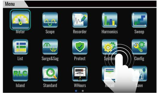
屏幕可以显示实时电压及电流曲线,最多可达6条示波数据线,用户无需示波器就可以进行瞬时分析,并及时进行保存。
