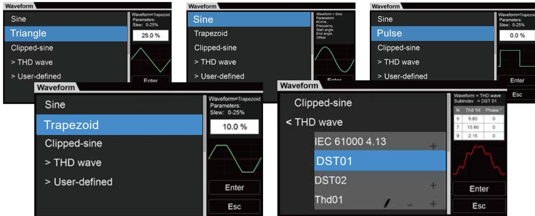
用户也可以通过界面的自定义模式编辑波形，用以模仿及再现问题发生现场的真实电源波形。
